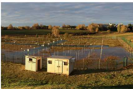
Le radar profileur de vent VHF, qui mesure le vent entre 1.5 et 16 km d'altitude. Il permet d'observer la dynamique de l'atmosphère jusqu'à l'interface entre la troposphère et la stratosphère. © Solène DERRIEN
