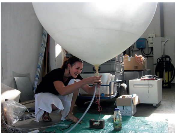
Gonflage d'un ballon de radiosondage de l'atmosphère. © Marie LOTHON
